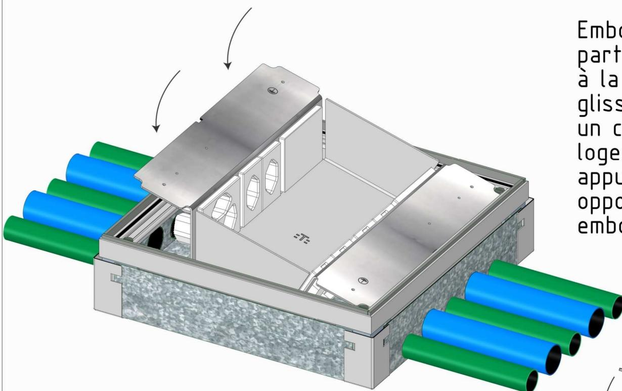
Emboîter la partie-active à la main en glissant d'abord un côté dans son logement, puis appuyer le côté opposé jusqu'à emboîtement.
